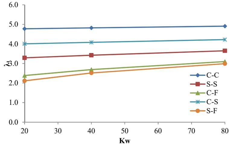
Fig. 10 First mode frequency parameter vs foundation parameter
